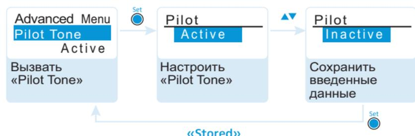
Пилот-сигнал поддерживает функцию отключения звукового тракта («**Squelch**») приемника. Благодаря этому предотвращаются помехи от радиосигналов других устройств. Пилот-сигнал имеет неслышимую частоту, которая передается передатчиком и обрабатывается приемником.
