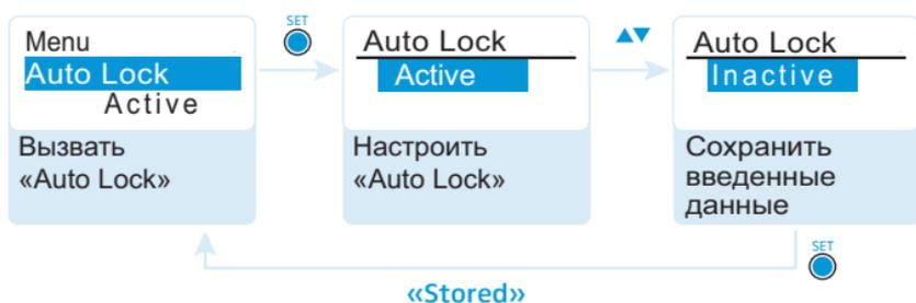
Эта блокировка предотвращает случайное выключение приемника или изменение его настроек. В текущем стандартном режиме индикации символ замка ⑤
