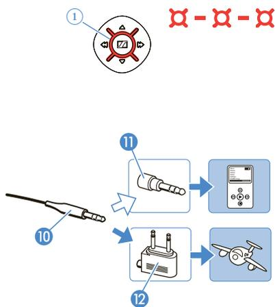
Если гарнитура уже подключена к источнику аудио сигнала через интерфейс Bluetooth, соединение Bluetooth автоматически прерывается при подключении аудио кабеля. Светодиодный индикатор ① ✕ трижды мигает красным, и Вы слышите затихающий звуковой сигнал.
