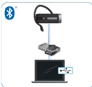
При использовании гарнитуры с программным телефоном (softphone) вам потребуется поддерживающий Bluetooth компьютер или дополнительный Bluetooth USB-передатчик (беспроводной аудио приёмник/передатчик).
