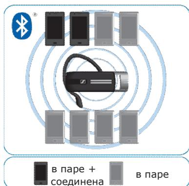
Гарнитура может работать одновременно только с двумя из максимум восьми возможных пар Bluetooth ("paired + connected" (сообщение "в паре + соединена").
