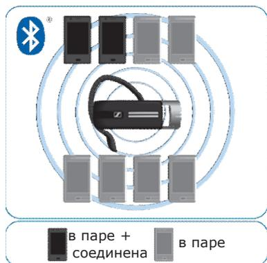
Гарнитура может хранить профили соединений с восемью устройствами Bluetooth, с которыми она работает в паре. После включения гарнитура автоматически пытается подсоединиться к двум устройствам, которые были подключены последними. После того, как выключены первое или второе Bluetooth-устройство, соединиться можно только с третьим.
