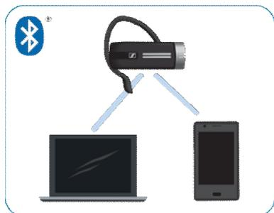
Гарнитура совместима со стандартом Bluetooth 4.0. Чтобы была возможна беспроводная передача данных с помощью технологии Bluetooth, необходимо соединение гарнитуры с Bluetooth-устройствами, поддерживающими профили «hands free» («свободные руки» — HFP), «headset profile» («гарнитура» — HSP) или «расширенное распределение аудио» (advanced audio distribution profile, A2DP).
