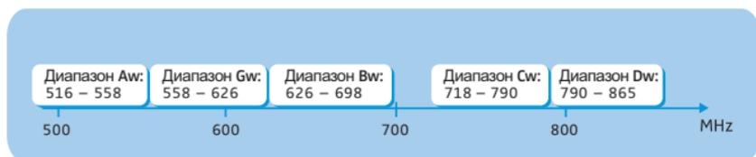
Каждый диапазон частот (Aw-Dw, Gw) имеет 26 канальных банков с 64 каналами в каждом:
