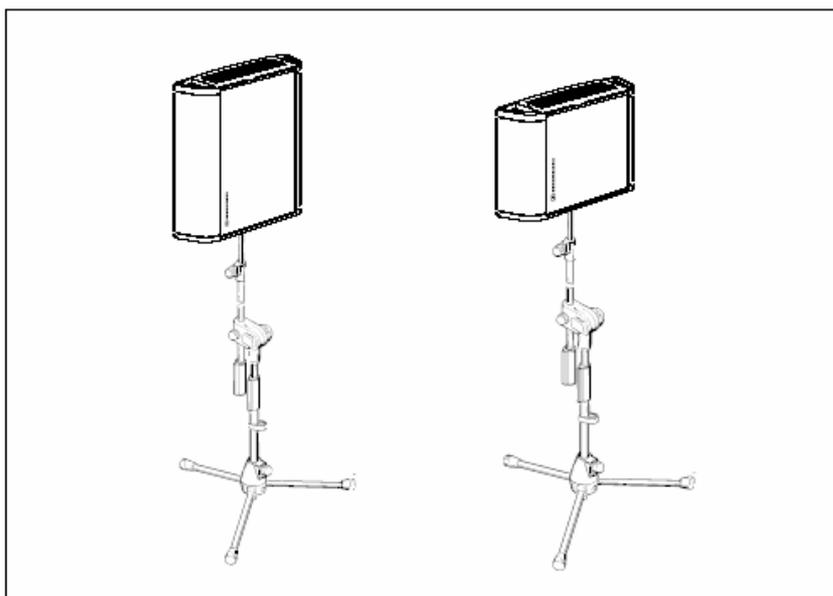
Излучатель SZI 1029 поставляется со встроенной резьбой для крепления на стойках с резьбой 3/8" или 1/2" через адаптер (включен в комплект поставки).
