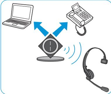
Имеется возможность работы системы гарнитуры со стационарной телефонной линией (телефонный режим **Phone**) и/или с PC (компьютерный режим **PC**). Базовая станция управляет беспроводной связью между компонентами.
